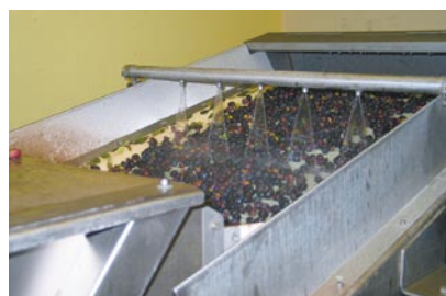
WASCHANLAGE. Hier werden die Oliven von Steinen, Blättern und Zweigresten befreit.
